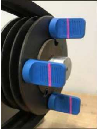
9. ábra – Függőleges szöghiba korrigálása
