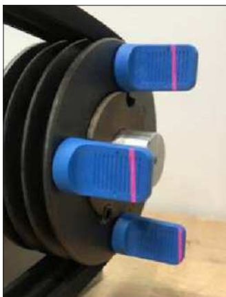
8. ábra – Mindehárom eltérés együttes kijelzése
