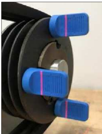
7. ábra – Párhuzamossági hiba kijelzése (eltolódás)
