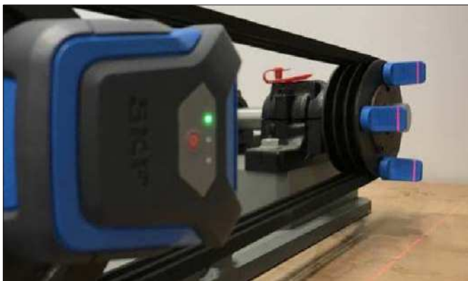
3. ábra – Szíjtárcsákra szerelt egységek
