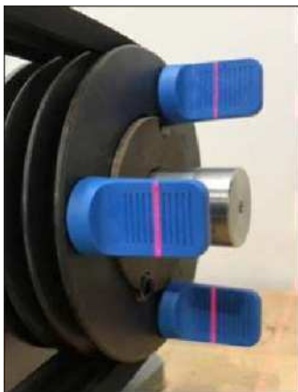
10. ábra – Vízszintes szöghiba korrigálása
