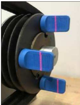
5. ábra – Függőleges szöghiba kijelzése
