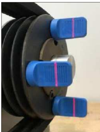
12. ábra – Tökéletesen beállított szíjtárcsák
